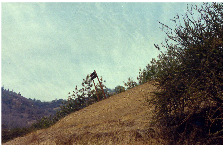
Fotografía n°4: Evidencias claras de la presencia de reptación en el sector norte de la ladera, la inclinación de la infraestructura, indica el movimiento lento pero continuo de la masa de regolita.
